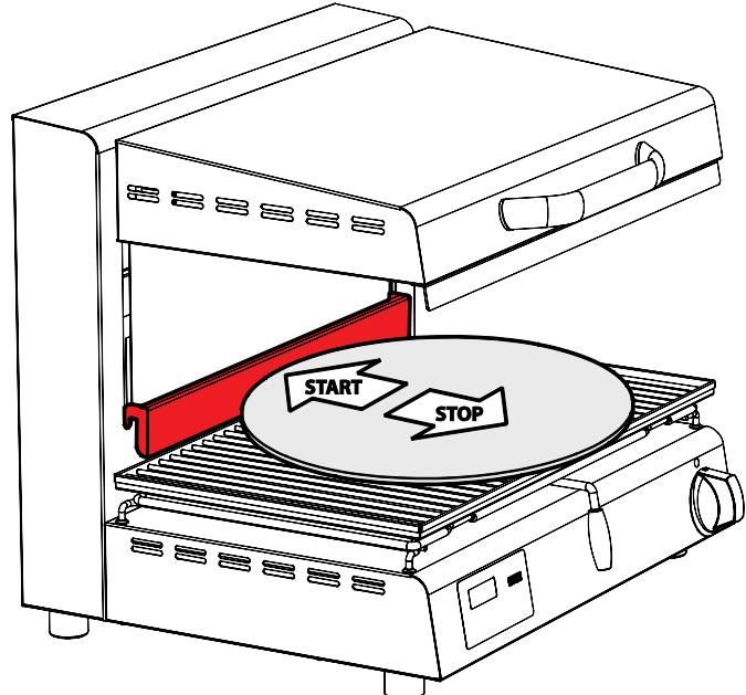
**En cas de panne de courant pendant la cuisson, une fois que celui-ci est revenu, le temps de cuisson qu'il manque à la fin de la cuisson clignotera sur l'afficheur. En appuyant sur la touche "START", l'appareil se remettra en marche à partir du temps affiché.**
