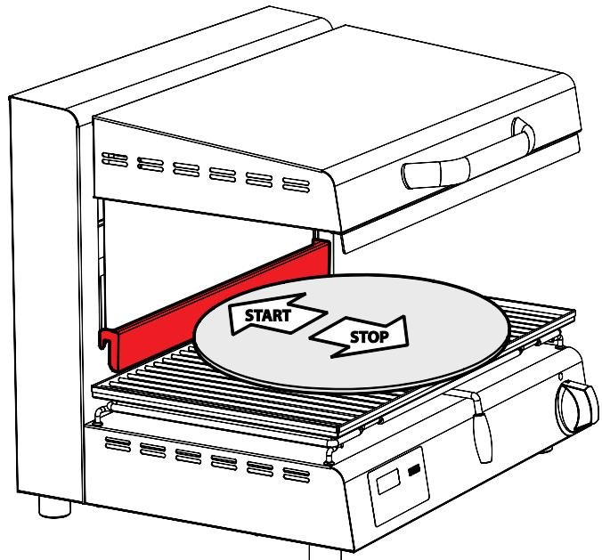
In caso di mancanza di tensione durante la cottura, al ripristino sarà evidente dal lampeggio del display il tempo rimanente di cottura al momento dell'evento. Premendo il tasto "START" l'apparecchiatura ripartirà da questa indicazione.
