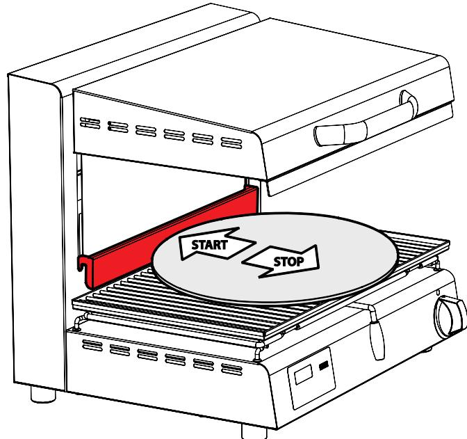
**En caso de falta de tensión durante la cocción, al restablecerse la tensión se mostrará con un parpadeo en la pantalla el tiempo de cocción que quedaba en el momento en que se ha producido este inconveniente. Apretando la tecla "START" el aparato volverá a iniciar su funcionamiento a partir de esta indicación.**
